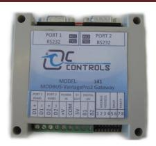
VPGateWay-141 Modbus VantagePro2 閘道器可以簡化 Davis Instruments Vantage Pro2 系列的氣象感測設備與 PLC (可程式化控制器), RTU (遠端通訊單元)或 SCADA (用戶通訊資訊拾取應用)系統之間的連接.可使用 Modbus RTU (Binary)協定控制,監看並取得風速風向,溫濕度其其它氣象參數資料.
